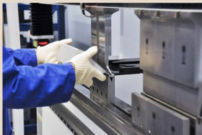
▲ 高い精度が必要な曲げもシミュレーションに基づき簡単に行える
