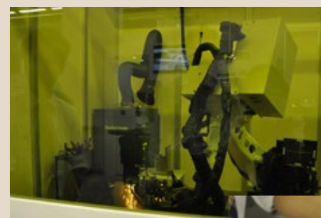
▲ レーザ切断とレーザー溶接を同時に行えるレーザー溶接ロボットシステム。(写真はSPHC板厚6.0ミリのレーザー切断)
